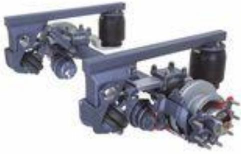
**Пневмоподушка** состоит из резиновой оболочки и пластиковых либо металлических составных элементов. Наружная поверхность резиновой оболочки обработана защитным составом, который препятствует повреждению ее неблагоприятными условиями внешней среды – грязи, соли, перепадов температур, ультрафиолетового излучения.
